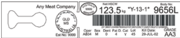
الصورة رقم 1: بطاقة الذبحة تحمل رمز الأعمدة المتوازية التابع لنظام مجلس الرموز الموحدة العالمية رقم 128
